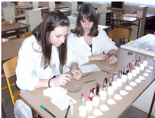
Slika 15: Priprava vzorcev ŠMI za analizo določanja vsebnosti svinca (foto: L. Lihteneker, 2009)
