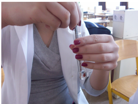
Slika 12: Dodajanje vzorca ŠMI v epruveto (foto: M. Jelen, 2009)
