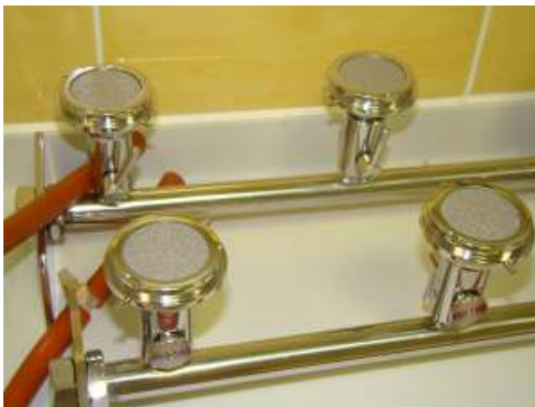
Slika 17: Membranska filtracija vzorcev vode (Foto: A. Trupej).
