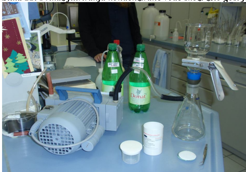
Slika 22: Prikaz filtriranja kondenzirane vode skozi zelo gost filter
