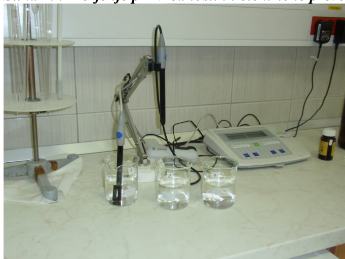
Slika 19: Merjenje pH vrednosti in električne prevodnosti vode
