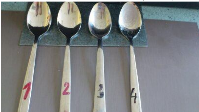
Slika 18: Sledi ostankov trdnih snovi v različnih vzorcih vode
