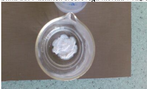
Slika 21: Nastanek srebrovega klorida v razredčeni klorovodikovi kislini (primerjalni vzorec)
