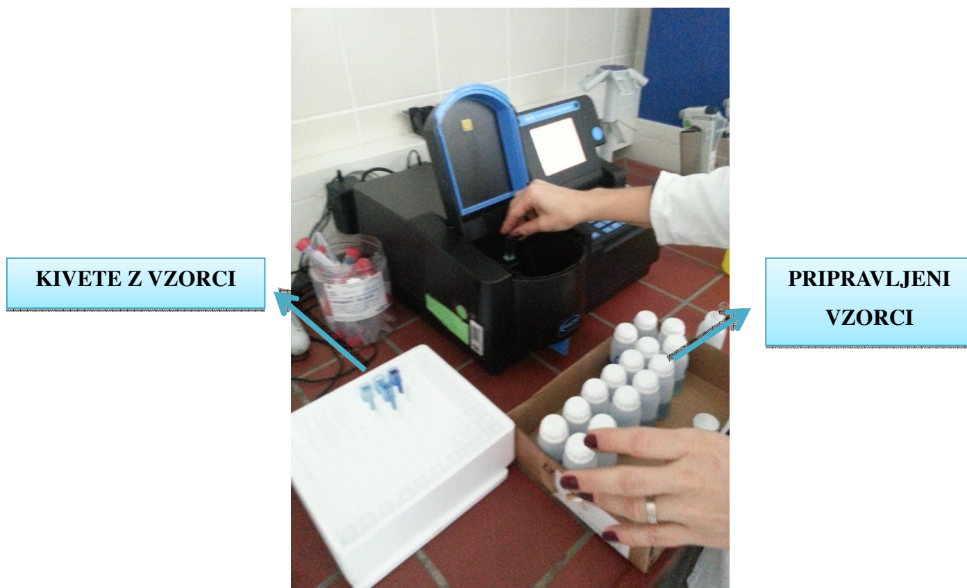
Slika 7: Določanje fosforja s spektrometrom Hach (Foto: D. Ćosić)
