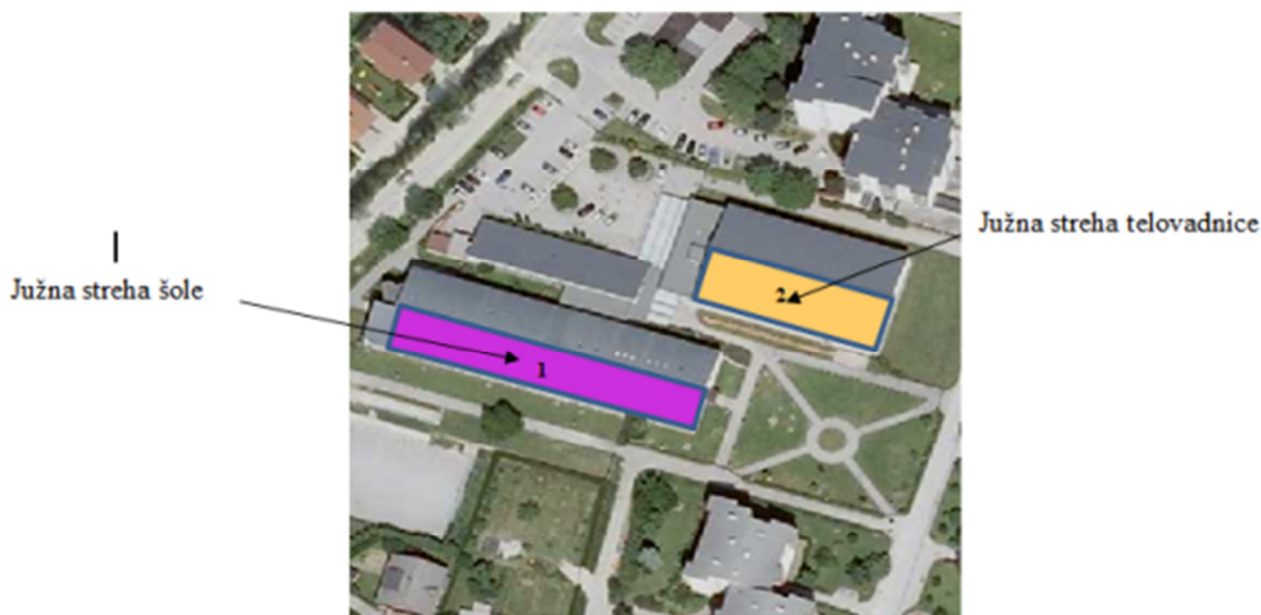
Slika 18: Površina strehe, ki je uporabna za postavitev sončne elektrarne (4)
