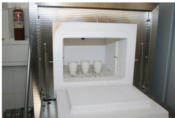
Slika 18: Peč za sežiganje vzorcev (Foto: B. Bubik)
