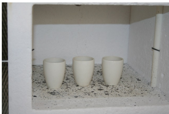
Slika 16: Porcelanasti lončki v peči za sežiganje (Foto: B. Bubik)
