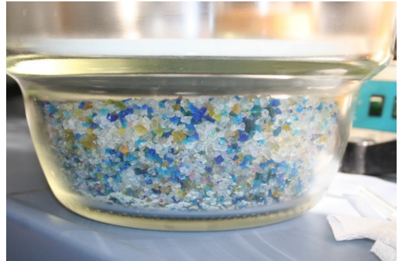
Slika 20: Silika gel v eksikatorju (Foto: B. Bubik)
