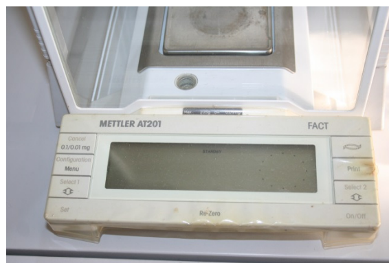
Slika 15: Precizna tehtnica (Foto: B. Bubik)
