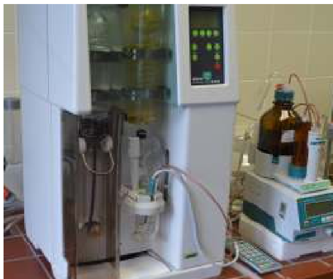
Slika 13: Aparat BÜCHI Distillation Unit B-324 (Foto: A. Breznikar)
