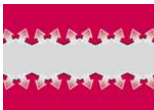
SLIKA 2: Adhezija je vezava lepila s podlago (O lepljenju ..., 2007).
