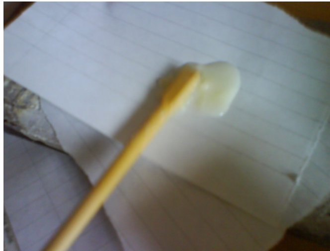
SLIKA 6: Nanašanje doma pripravljene lepila iz mleka (Foto: Z. Grudnik).
