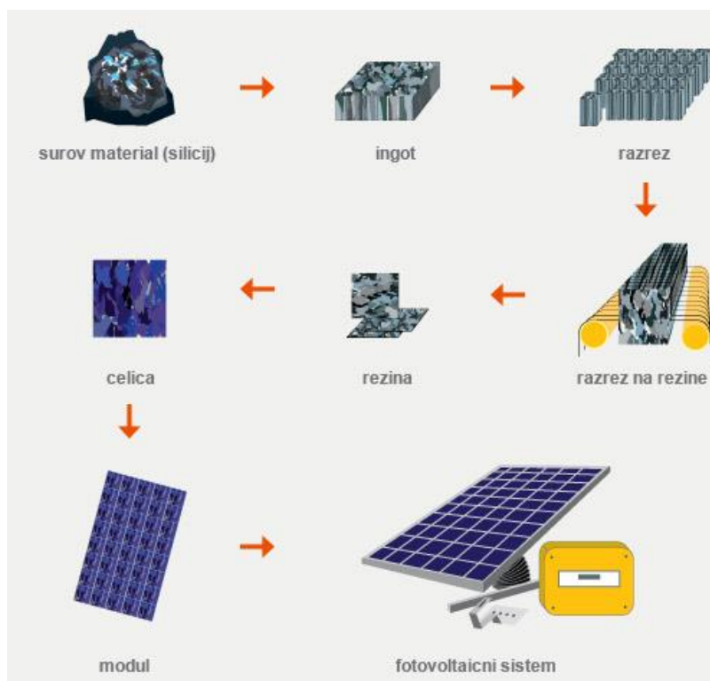
Slika 1: Postopek izdelave solarnega modula
