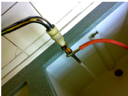
Slika 17; Vodna črpalka , avtor: Vesna Arlič
