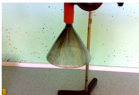
Slika 19; Saje na lijaku pri gorenju ohišja sveče iz PVC, avtor: Srečko Terzić
