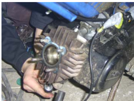
Slika 14: Demontaža izpušne cevi
