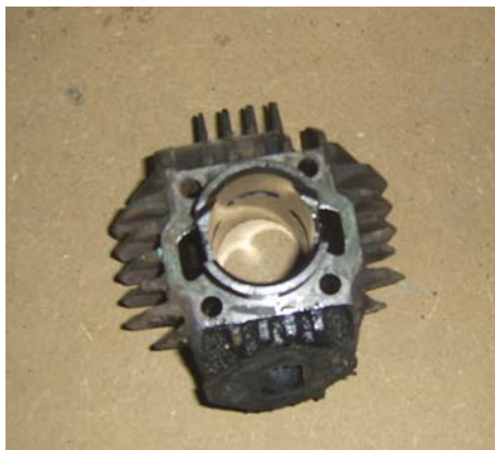
Slika 15: Demontiran valj prostornine 49 ccm
