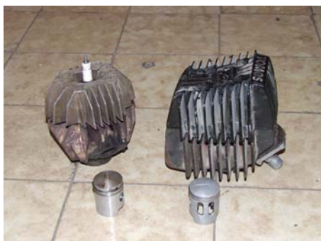
Slika 21:Primerjava obeh valjev in batov
