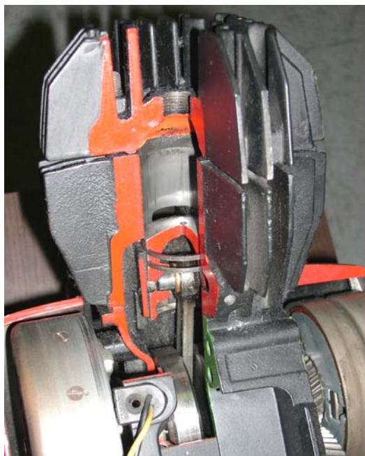
Slika 1: Prerez dvotaktnega motorja
