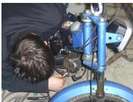
Slika 13: Demontaža kape in valja
