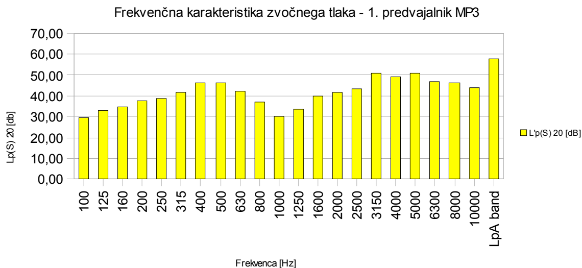
Graf 18: Frekvenčna karakteristika zvočnega tlaka - 1. predvajalnik MP3
