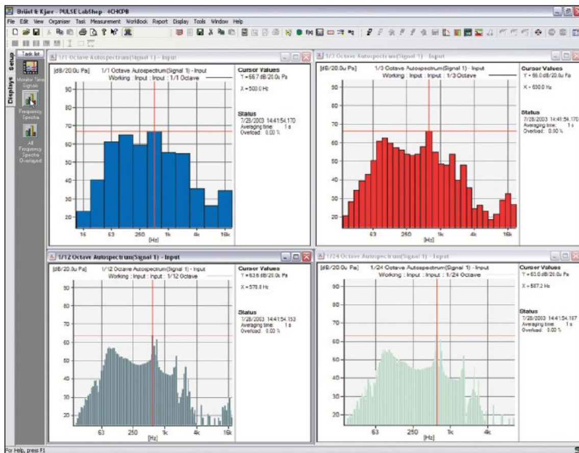
Slika 21: Programski del – CPB analiza zvoka in vibracij 7771
