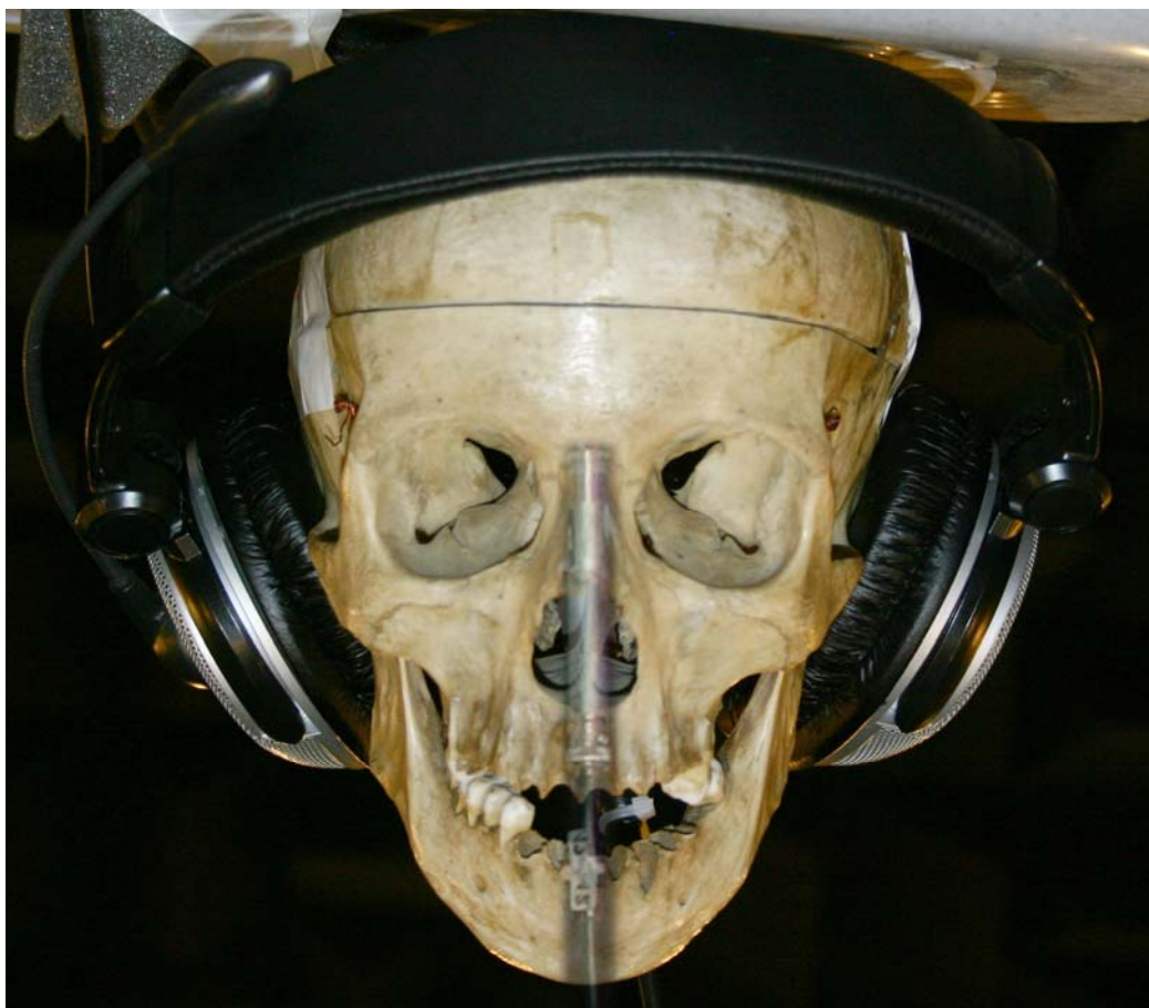
Slika 26: Meritve smo izvajali s pomočjo mikrofona, ki je bil nameščen v sredini človeške lobanje
