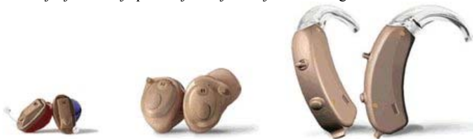
Slika 29: Tri glavne vrste slušnih aparatov: sluhovodni, vušesni, zauheljni (z leve proti desni)
