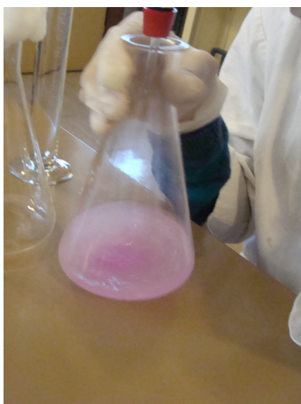
Slika 7: Preskok barve v rahlo rožnato pri določanju kislinske stopnje (Foto: E. Kozman).
