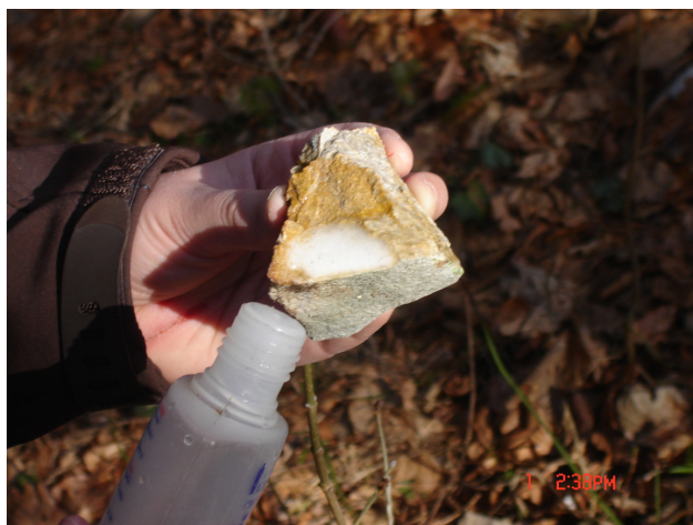
Slika 2: Določanje apnenca s klorovodikovo kislino.
