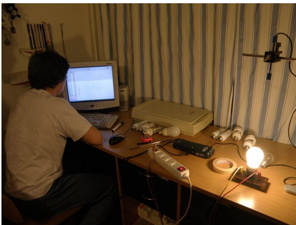
Slika 11: Izvajanje meritev z lux metrom (Foto: B. Gortan).
