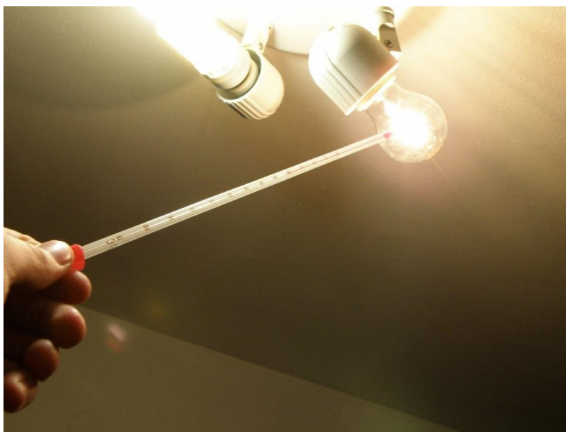
Slika 13: Merjenje temperature žarnic s pomočjo alkoholnega termometra (Foto: B. Gortan).
