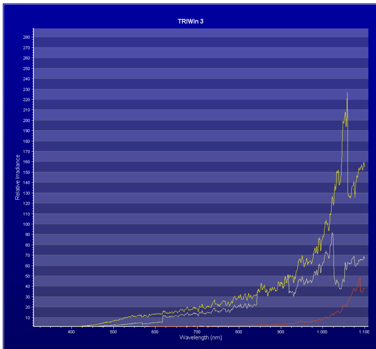
Graf 11: Navadna žarnica takoj po prižigu, po dveh minutah, po treh minutah.
