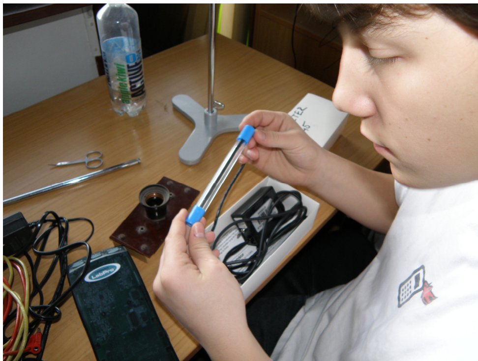
Slika 9: Z lux metrom lahko merimo svetilnost žarnic (Foto: B. Gortan).
