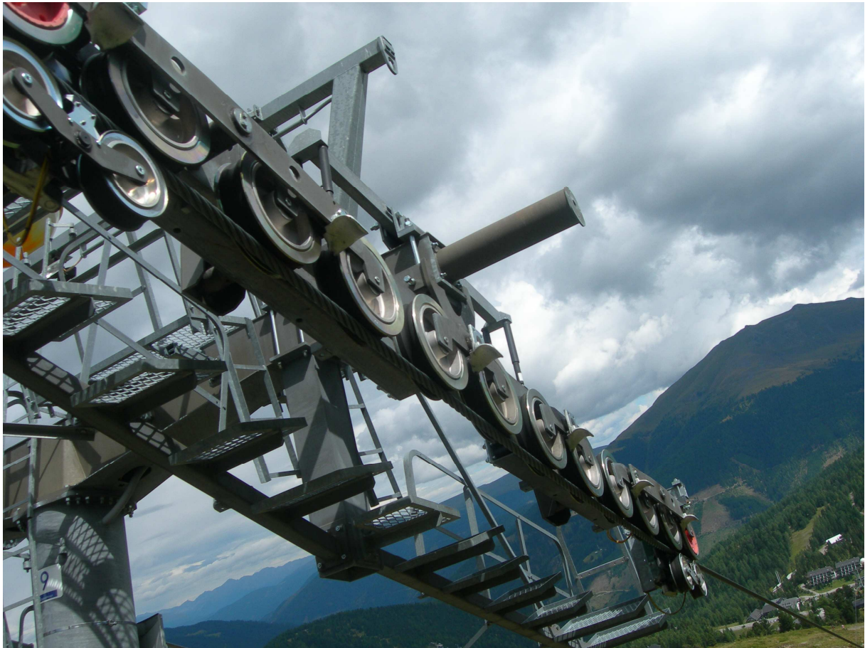
Slika 9: Lovilni čevlji na negativni bateriji proizvajalca Doppelmayrja na Turacher Höhe (Avstrija).
