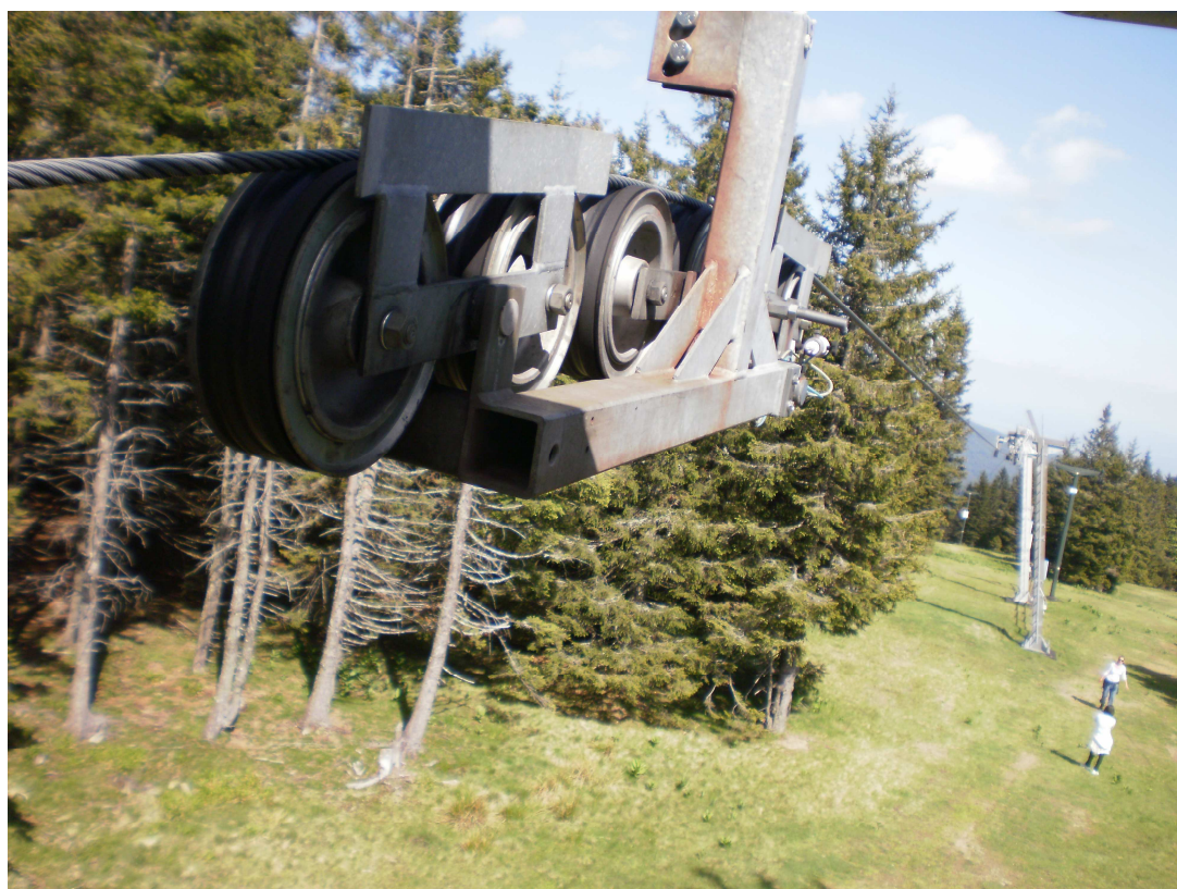
Slika 7: Fotografija fiksne pozitivne baterije na stebru.
