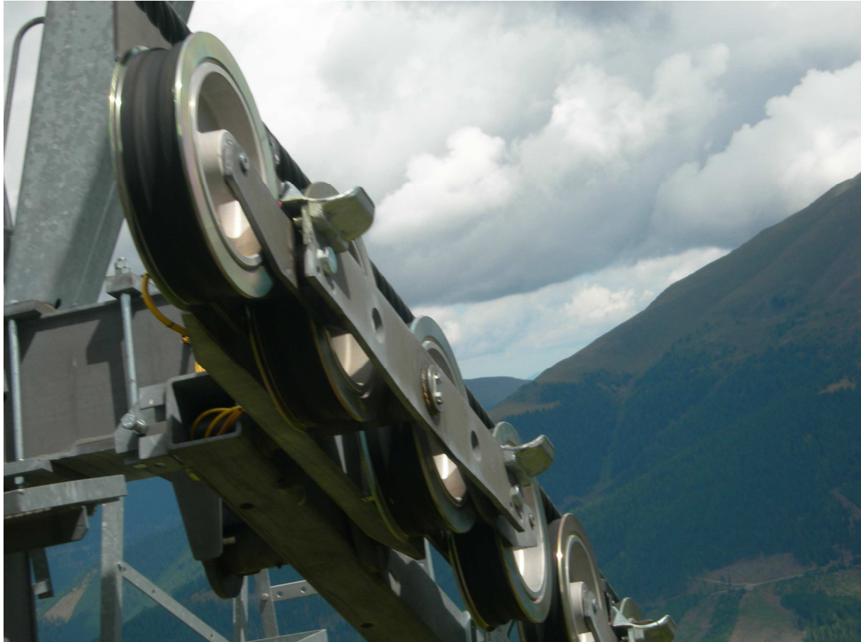
Slika 8: Lovilni čevlji na pozitivni bateriji proizvajalca Doppelmayrja na Turacher Höhe (Avstrija).
