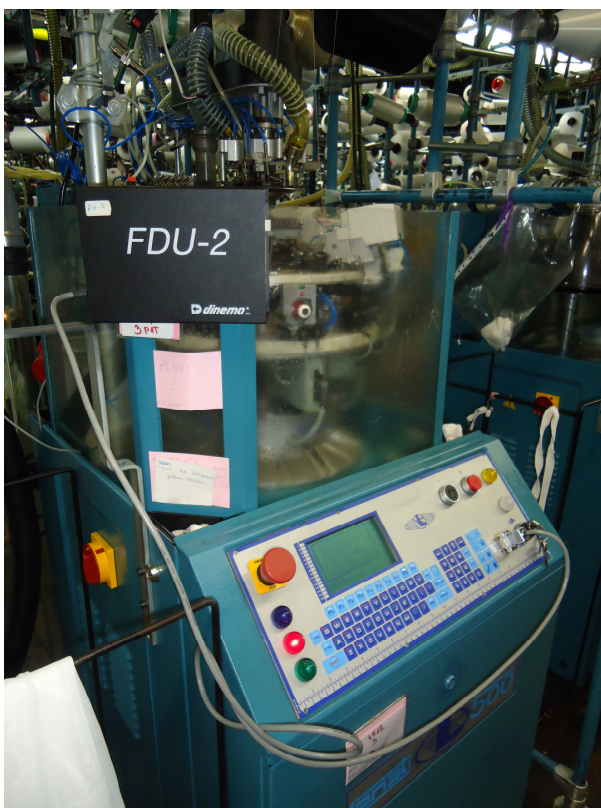
Slika 15: Prenos programa na stroj in izdelovanje nogavice [ foto: Andreja Slokar ]
