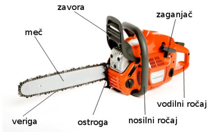
Slika 2: Osnovni sestavni deli motorne žage
