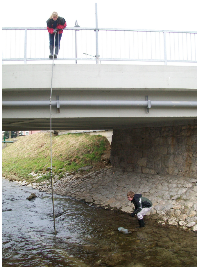
Slika 3: Izvedba meritev z vodomerno lestvico
