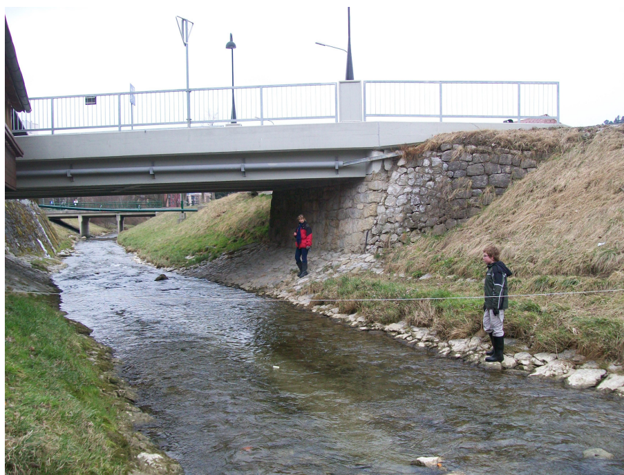
Slika 4: Merjenje hitrosti toka reke Pake
