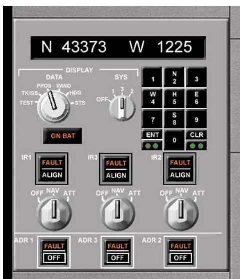
Slika 22: ADIRU panel na letalu A320 (ADIRU služi enakemu namenu kot IRS)
