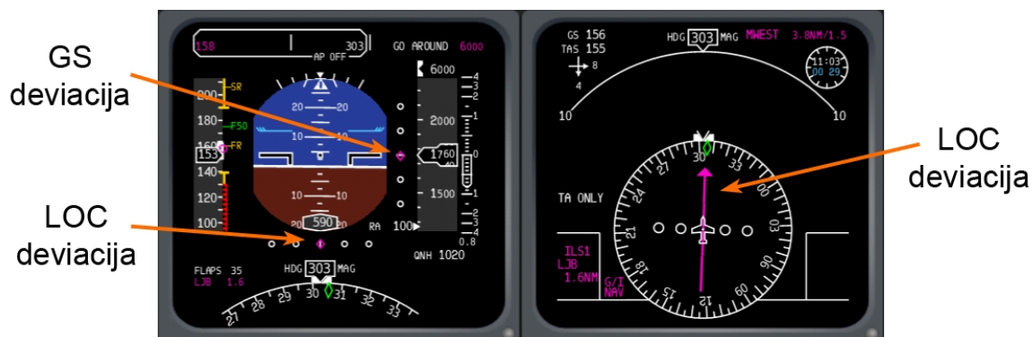
Slika 59: Prikaz ILS signalov na zaslonih modernih letal
