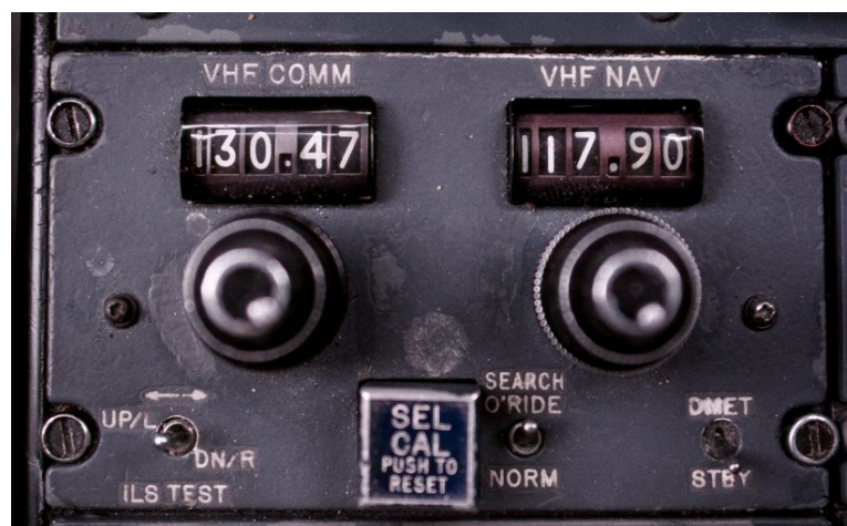
Slika 19: Radio panel na letalu B727. Z desnim vrtljivim gumbom nastavljamo frekvenco VOR-ov in ILS-ov
