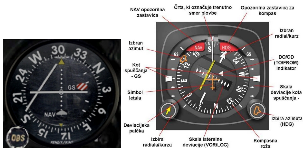
Slika 21: CDI na levi in HSI na desni
