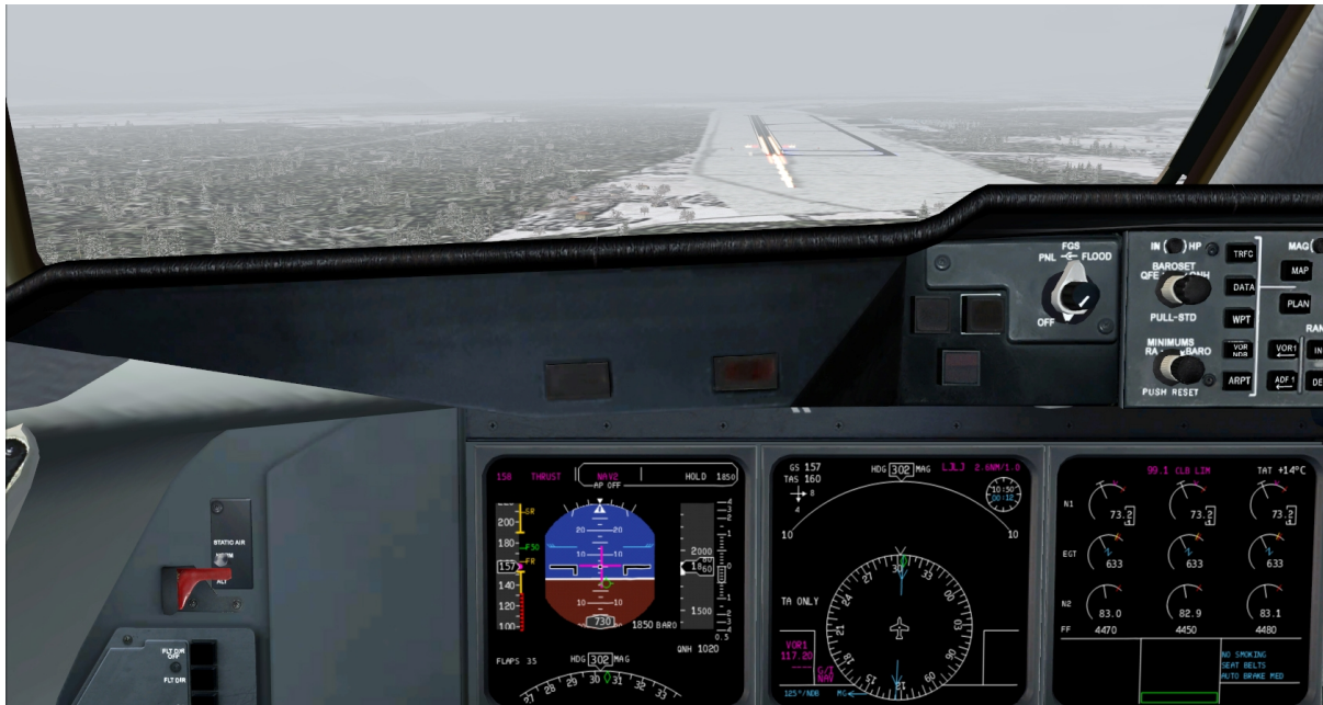
Slika 58: Pogled skozi okno pilotske kabine na MDA med NDB priletom
