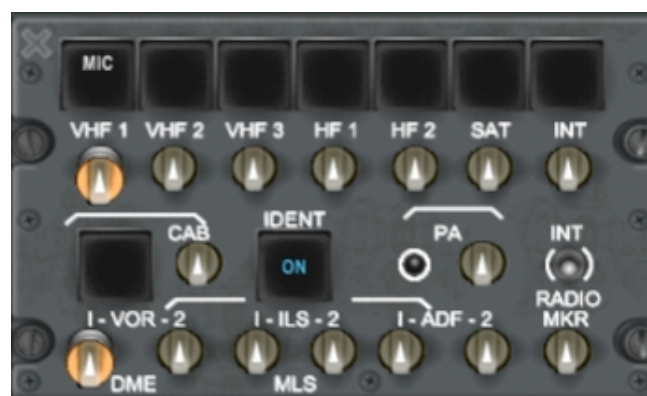
Slika 20: Nastavljen radio panel za poslušanje identifikacije VOR oddajnika na letalu (MD-11 s prižganim IDENT gumbom na frekvenci VOR 1 in aktivirano frekvenco za komunikacijo s kontrolo letenja – VHF 1 - od možnih prednastavljenih treh).
