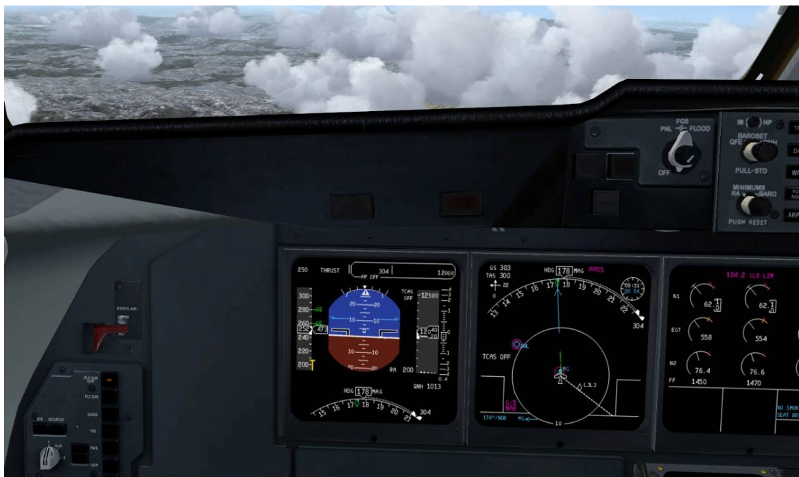
Slika 46: Letenje po KLM metodi do zelenega QDM 175 MG v MS Flight Simulator 2004 z letalom MD-11 proizvajalca PMDG
