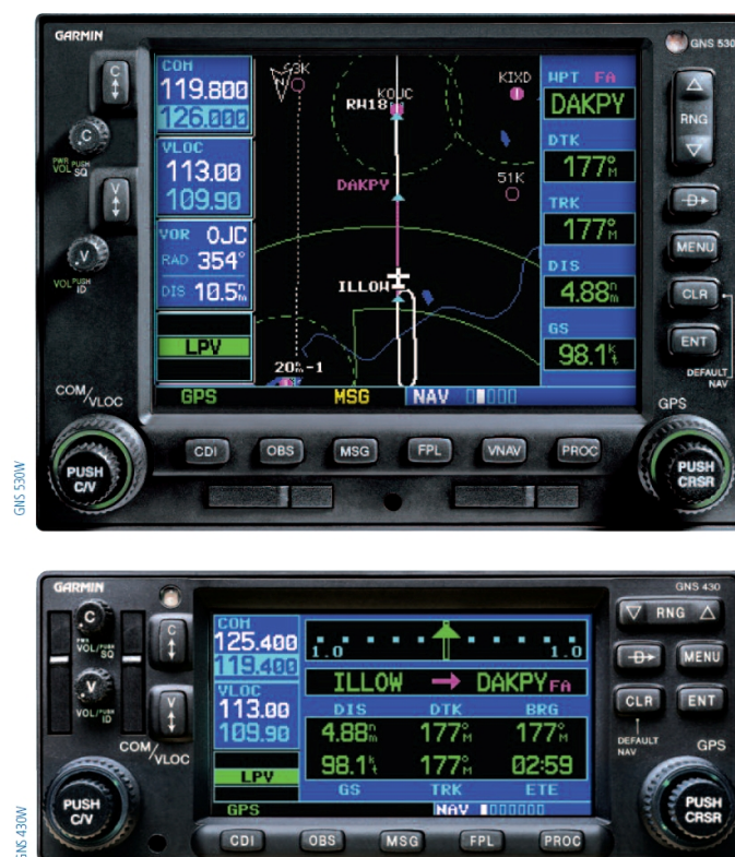
Slika 43: GNS 530W (zgoraj) in GNS 430W (spodaj)
