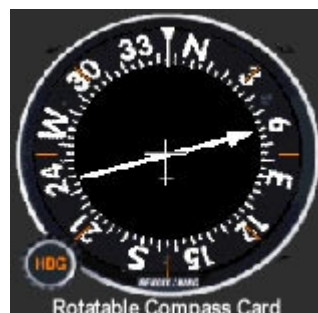
Slika 10: ADF z vrtljivo kompasno rožo
