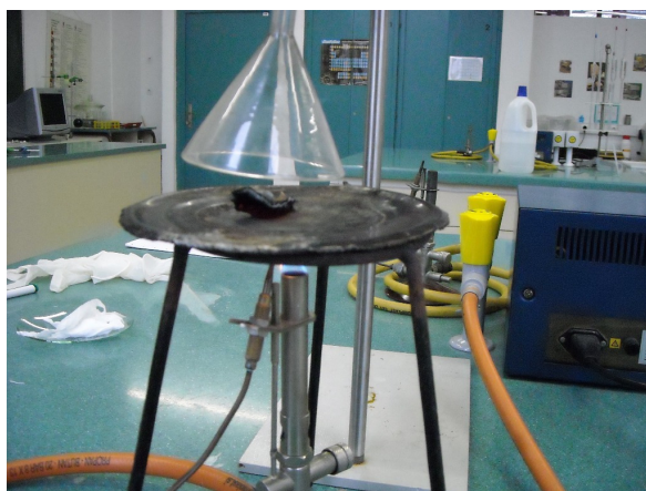
Slika 11: Ostanki plenice za enkratno uporabo (foto: Srečko Terzić, 2010)
