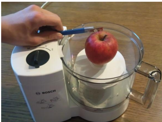
Slika 27: Testiranje lupilnika z noži
