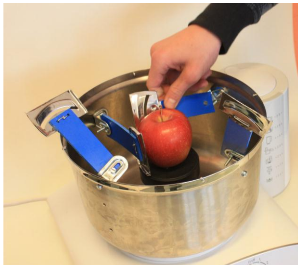
Slika 37: Nameščanje nožev nabodalo
