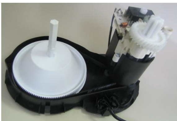
Slika 23: Pogonski del kuhinjskega aparata MCM 2050
