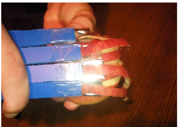
Sliki 25 in 26: Rezalna plošča in izrezani noži kuhinjskega aparata MCM 2050
