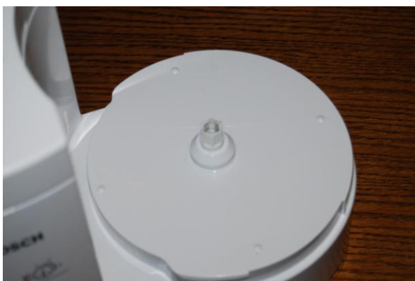
Slika 19: Skrajšana gred aparata
