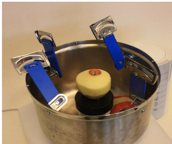
Slika 39: Posoda z dvignjenimi noži in olupljenim jabolkom
