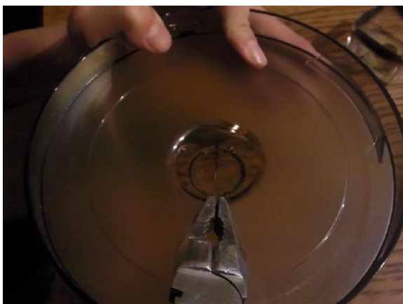
Slika 17: Odstranjevanje srednjega dela posode
