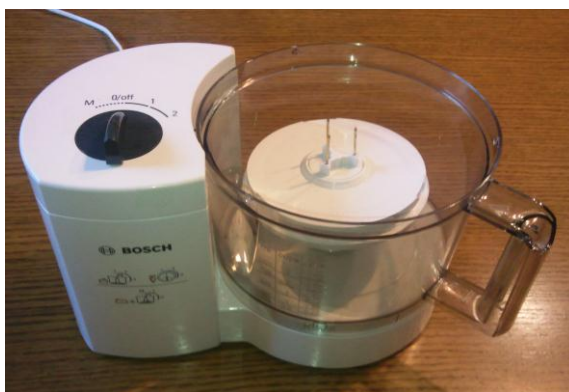
Slika 24: Predelan kuhinjski aparat MCM 2050 z dodanim reduktorjem in tritočkovnim nabodalom
