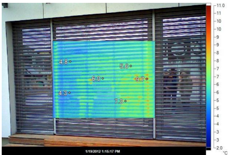
Slika 11: Temperaturna razporeditev na zastrtem oknu
