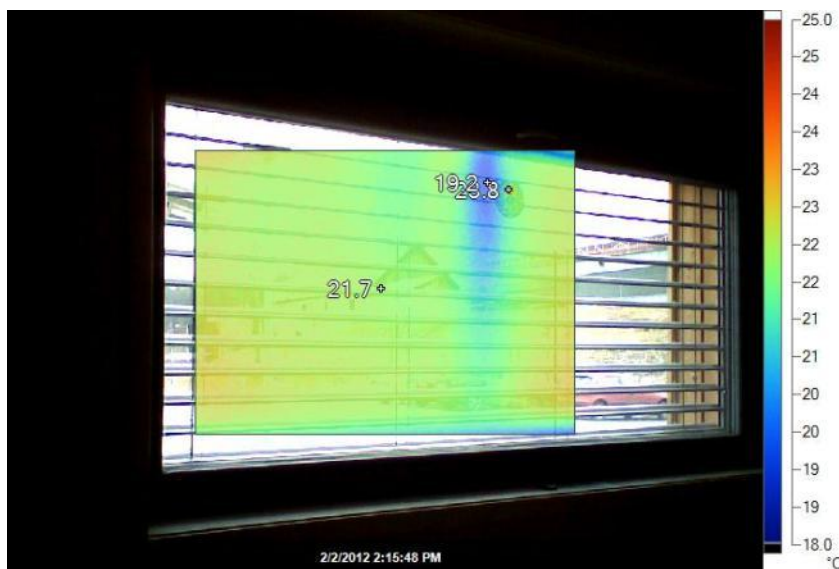
Slika 22: Temperature na steklu manjše kot drugje
