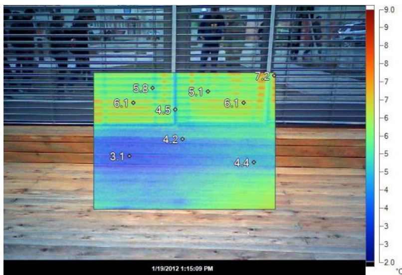
Slika 10: Primerjava okna z lesenim delom fasade
