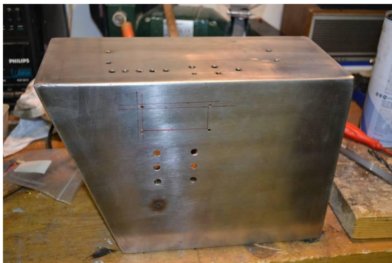
Slika 19: Omarica za elektroniko in baterije
