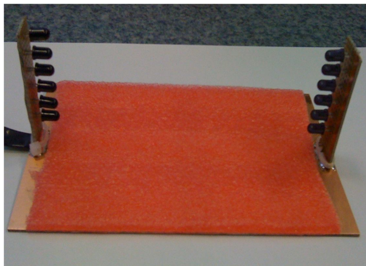
Slika 17: Svetlobna zavesa (senzor-LED diode in FOTO tranzistorji)
