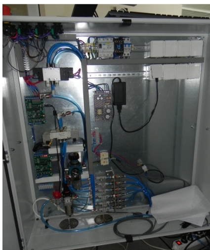
Slika 28: Plošča elektro omare z vsemi elementi razen dušilk
