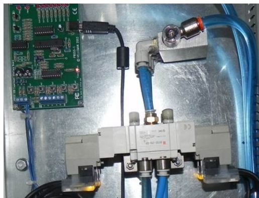
Slika 39: SMC ventili, Velleman k8055n in aluminijast razdelilnik zraka
