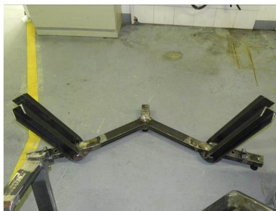
Slika 41: Oporna stebra za cilindra
