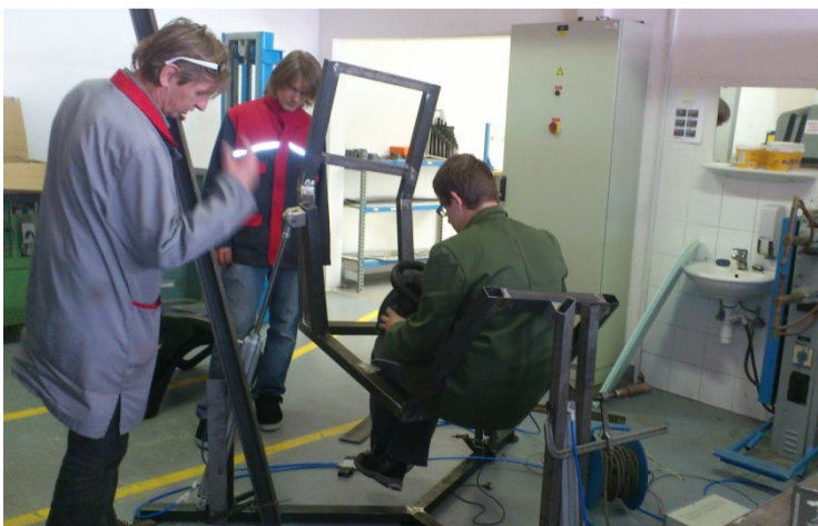
Slika 29: Nameščanje opornih stebrov za cilindre
