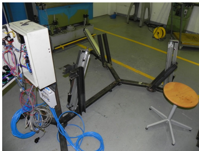
Slika 12: Potenciometri na vseh cilindrih
