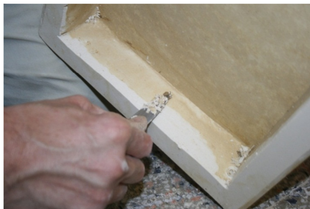
Slika 7: Retuš popravilo kalupa
