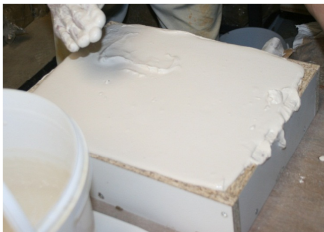
Slika 5: Vlivanje mavca v kalup
