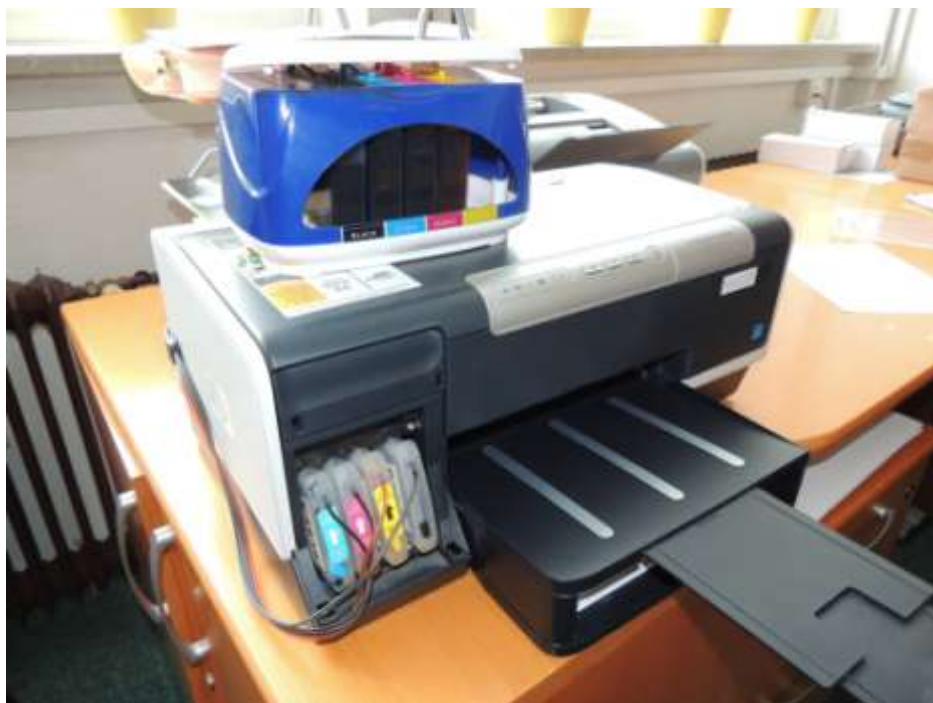
Slika 13: Tiskalnik z vgrajenim CISS sistemom (M. Oblišar).
