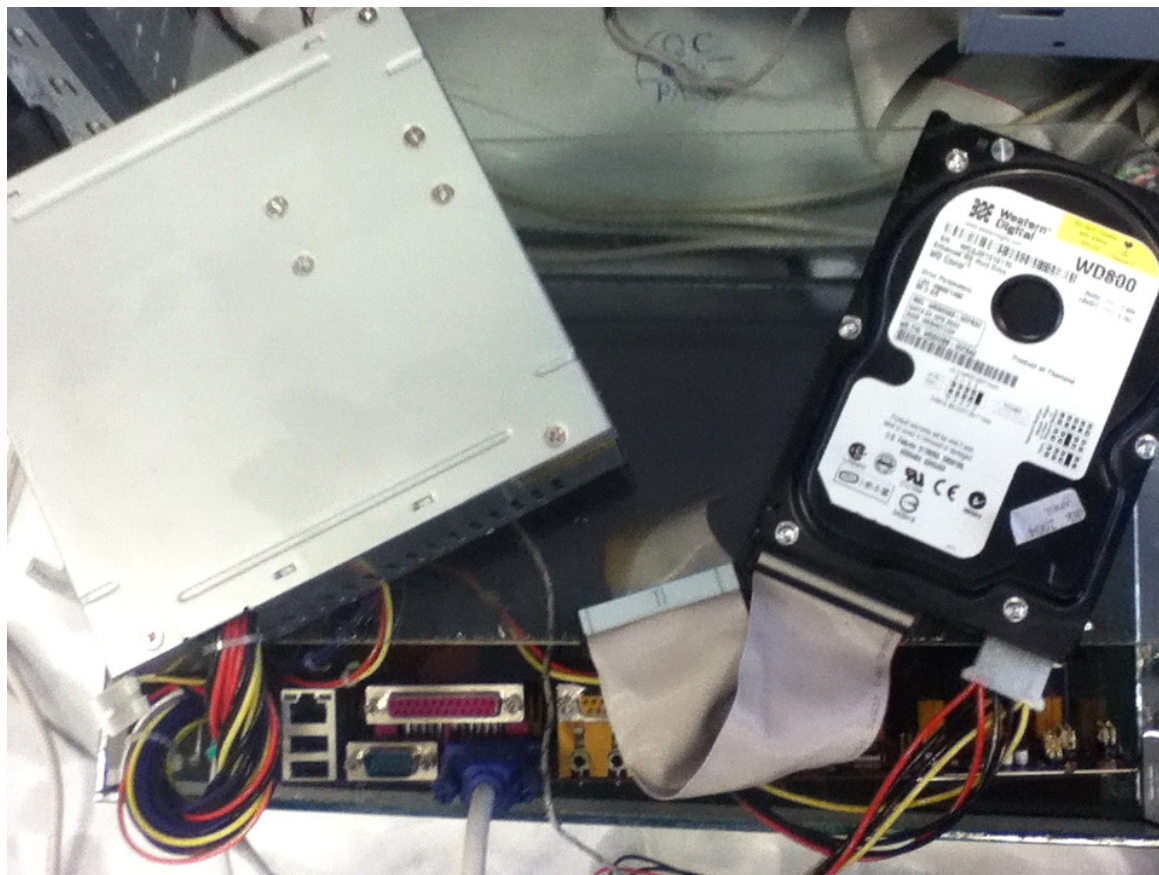
Slika 13: Računalnik v olju brez črpalke in hladilnika2
