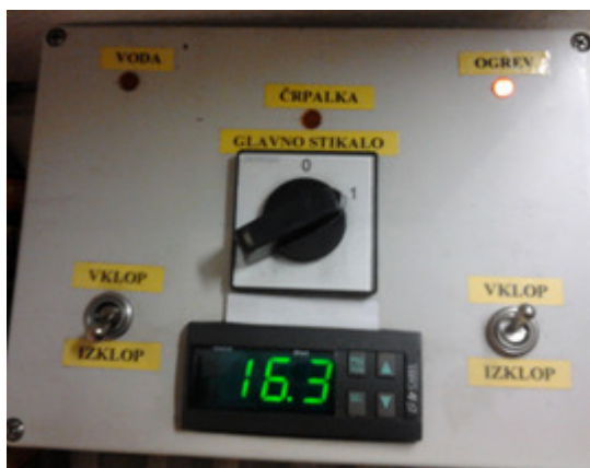
Slika 22: Test avtomatskega uravnavanja temperature (levo možnost nadzora vlage) (Foto: V. Delopst)
