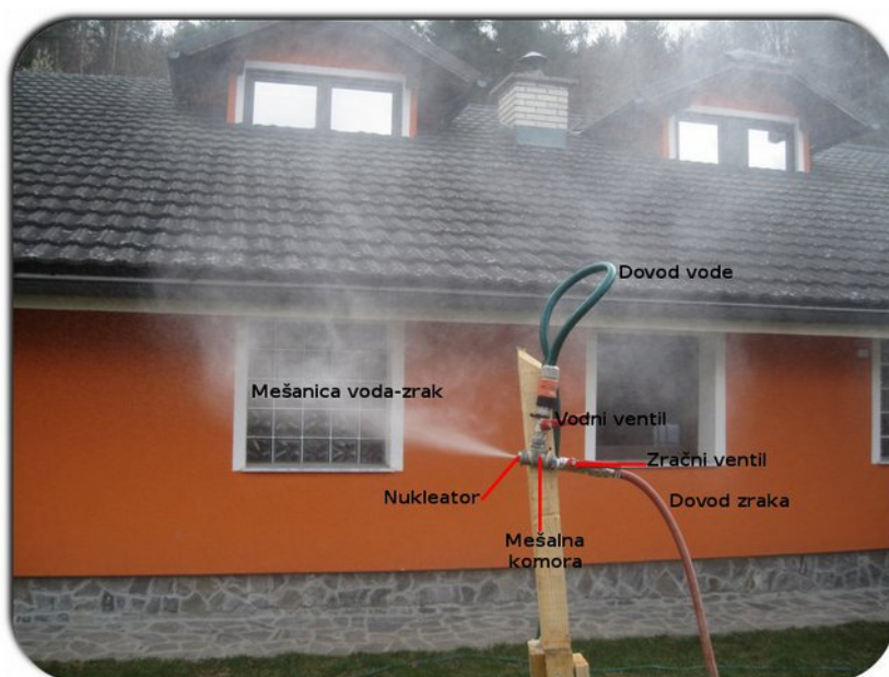
Slika 17: Primer testiranja izvedbe T-snežnega topa, foto: M. Sever
