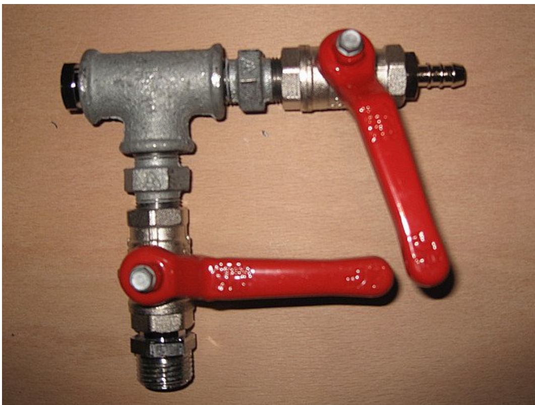
Slika 1: Osnovna izvedba domače izdelanega T-snežnega topa (Foto: M. Sever)
