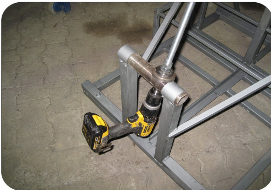
Slika 43: Sistem za spuščanje in dvigovanja roke, foto: Ž. Korpar
