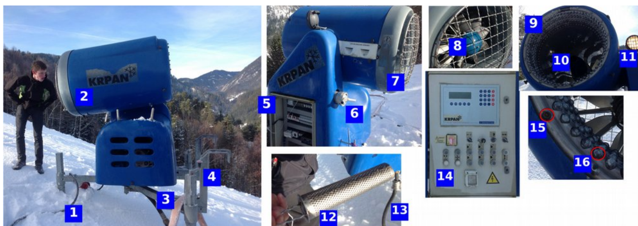
1 Električni dovod 2 Ohišje snežnega topa 3 Dovod vode 4 Nosilna konstrukcija 5 Elektro omarica 6 Ročka vodnega filtra 7 Zaščitna mreža 8 Ventilator 9 Šobe 10 Ventilator 11 Reflektor 12 Vodni filter 13 Električni kabel 14 Krmililna omarica 15 Nukleatorska šoba 16 Vodna šoba
