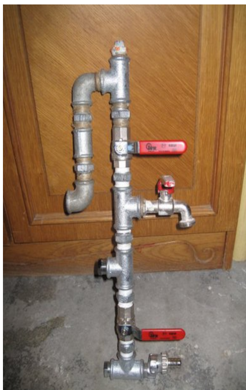
Slika 18: Primer sestavljenega kombiniranega snežnega topa, foto: M. Sever
