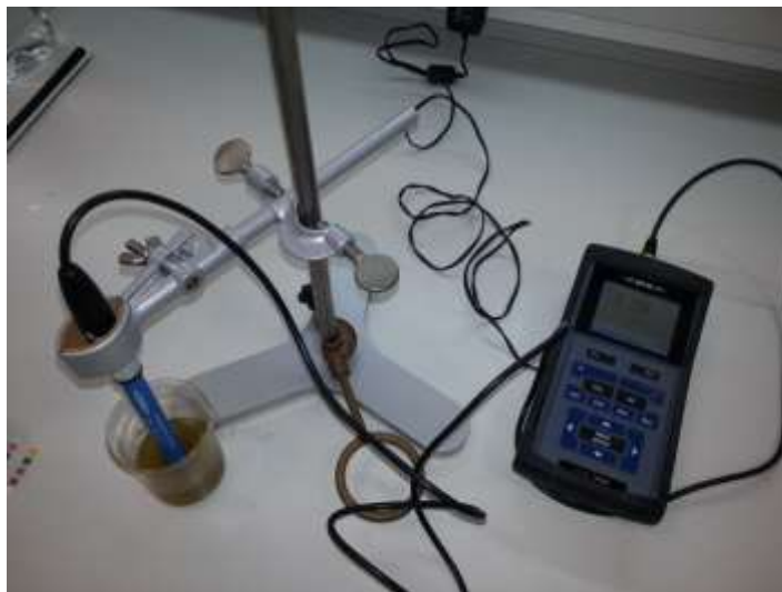
Slika 12: Merjenje pH s pH metrom (Foto J. Zabukovnik)
