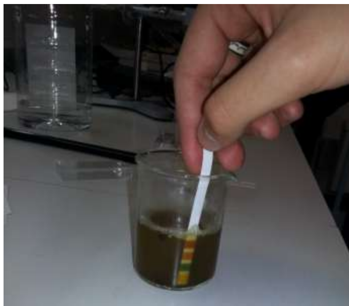
Slika 11: Merjenje z »bolj natančnimi« pH lističi (Foto J. Zabukovnik)
