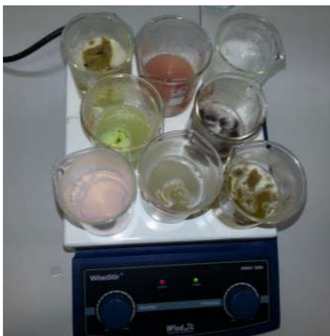
Slika 9: Segrevanje mil na kuhalniku z magnetnimi mešali (Foto J. Zabukovnik)
