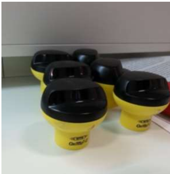
Slika 15: OxiTop merilne glave (Foto: A. Žagar)
