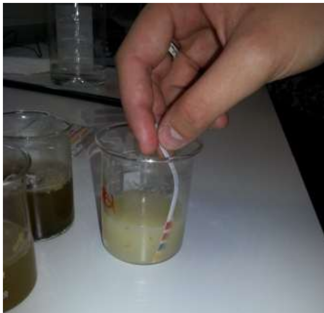
Slika 10: Merjene z »manj natančnimi« pH lističi (Foto J. Zabukovnik)
