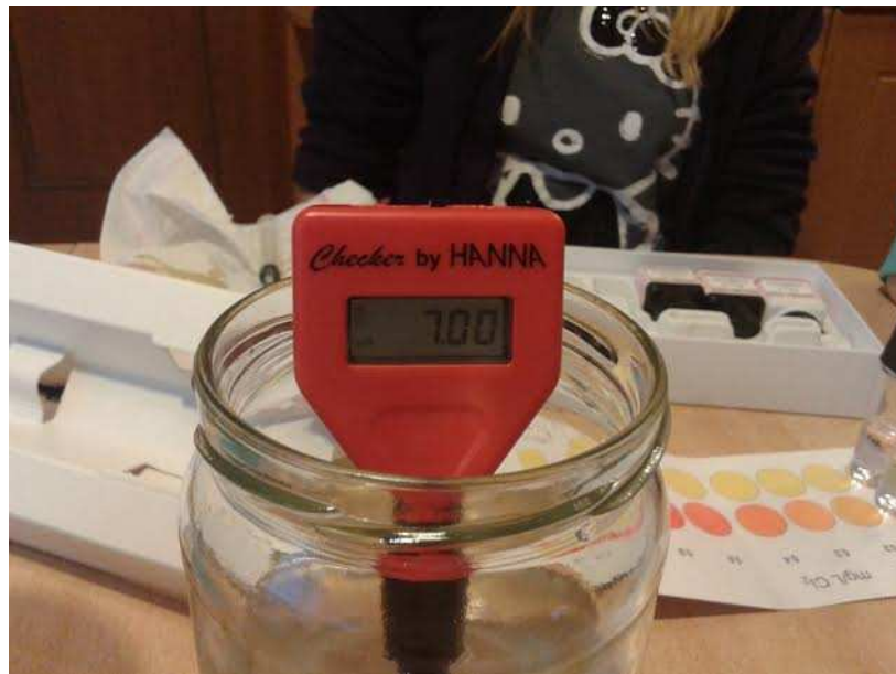
Slika 8: Merjenje pH z elektronskim pH metrom (Foto: A. Pustinek).
