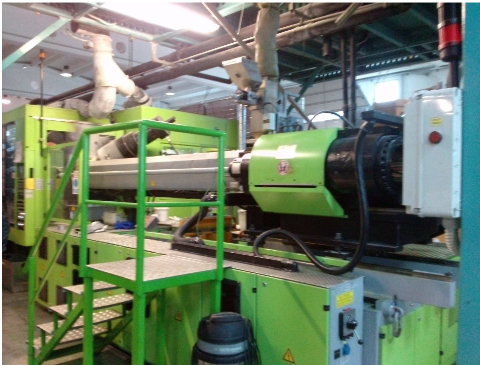
Slika 2: Brizgalni stroj iz tovarne GastroPET (foto J. Lesjak).
