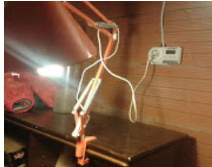
Slika 18: Merjenje porabe el. energije varčne žarnice (I. Košak)
