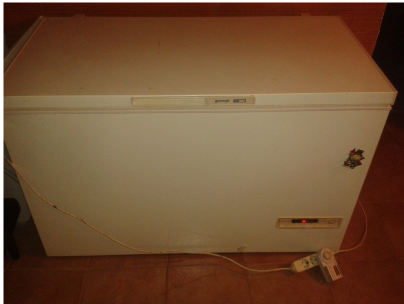
Slika 7: Merjenje porabe električne energije zamrzovalne skrinje (I. Košak)
