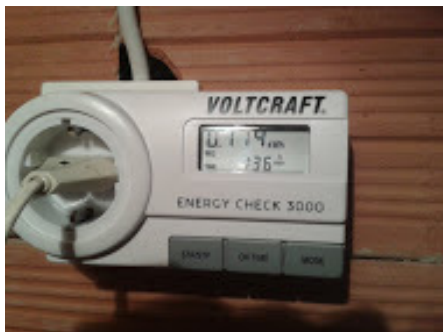
Slika 19: Izvajanje meritev – navadna žarnica (I. Košak)
