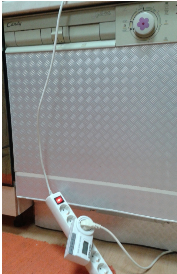
Slika 14: Merjenje porabe el. energije starega pomivalnega stroja (I. Košak)
