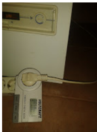
Slika 8: Izvajanje meritve porabe el. energije stare zamrzovalne skrinje (I. Košak)
