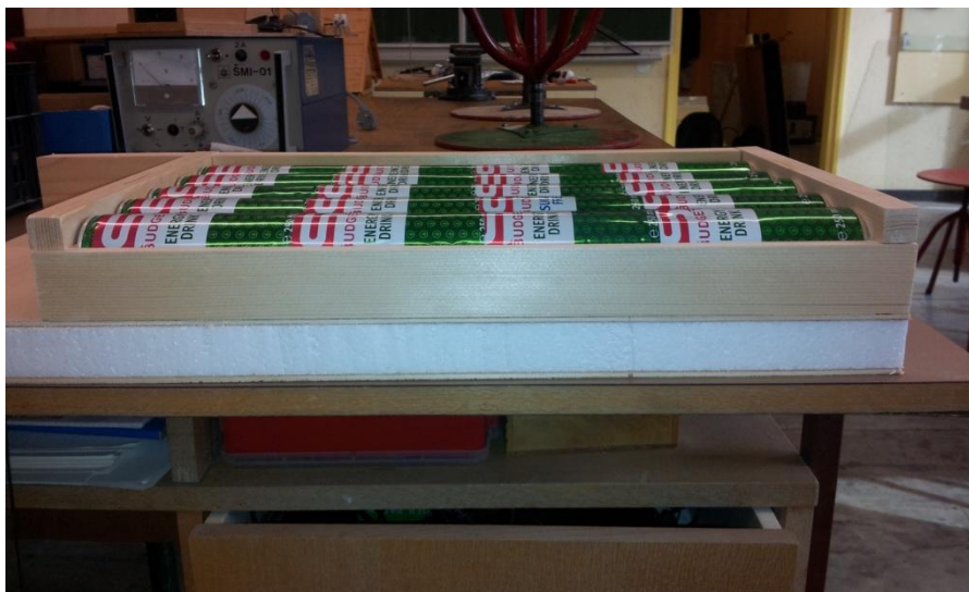
Slika 11: Prerez sončnega zbiralnika toplote (Foto: N. Lesnjak).
