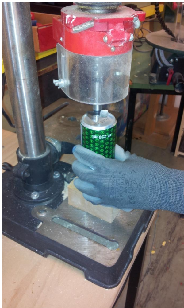
Slika 8: Vrtanje lukenj v pločevinke (Foto: D. Vodušek).
