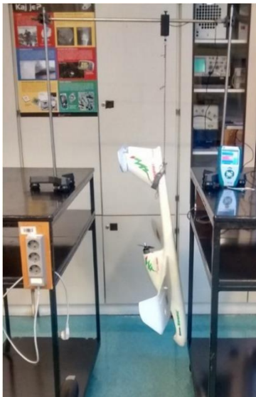
SLIKA 10: MERJENJE POTISNE SILE Z MERILNIM SISTEMOM VERNIER
