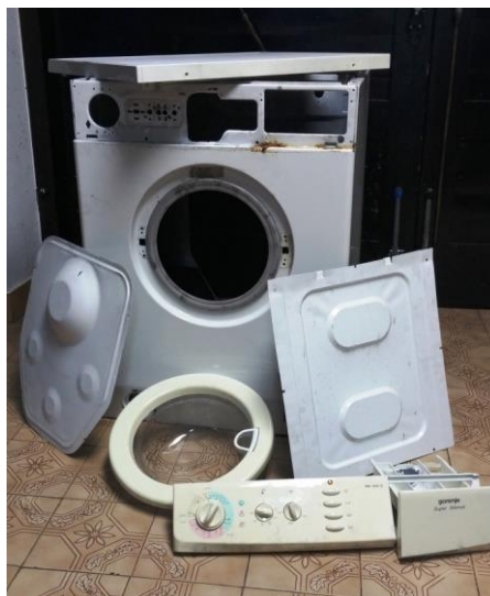
Slika 7: Deli pralnega stroja, ki niso uporabni pri izdelavi novega izdelka (foto: Andrej Cevzar)
