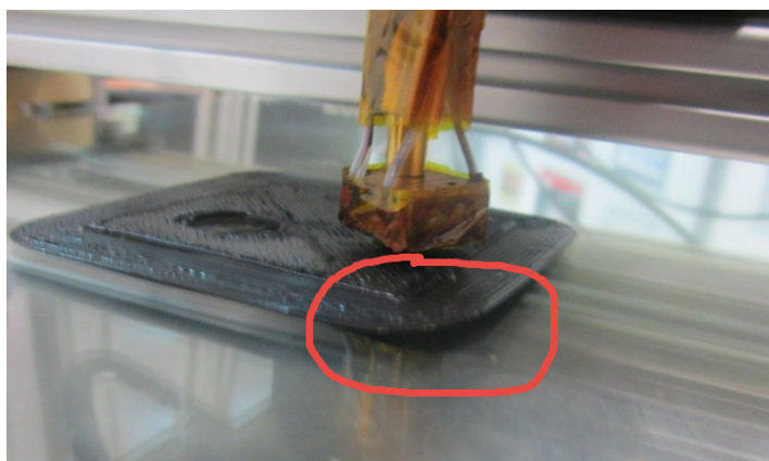
Slika 25: Tiskanje vzorčnega modela pri temperaturi delovne mize 80 °C (vir: lastni)
