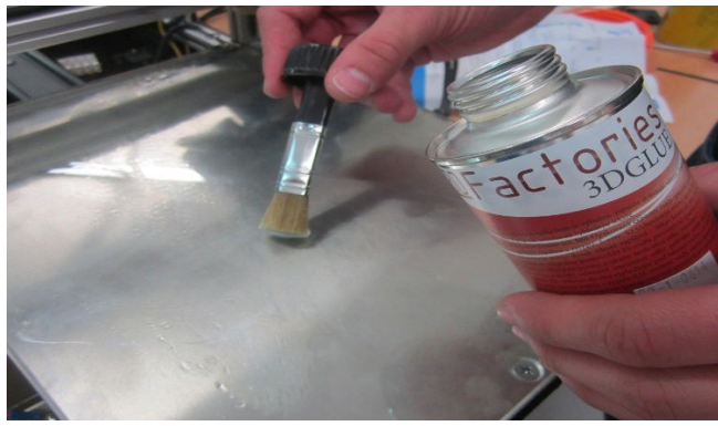
Slika 30: Nanos profesionalnega lepila na delovno površino mize (vir: lastni)
