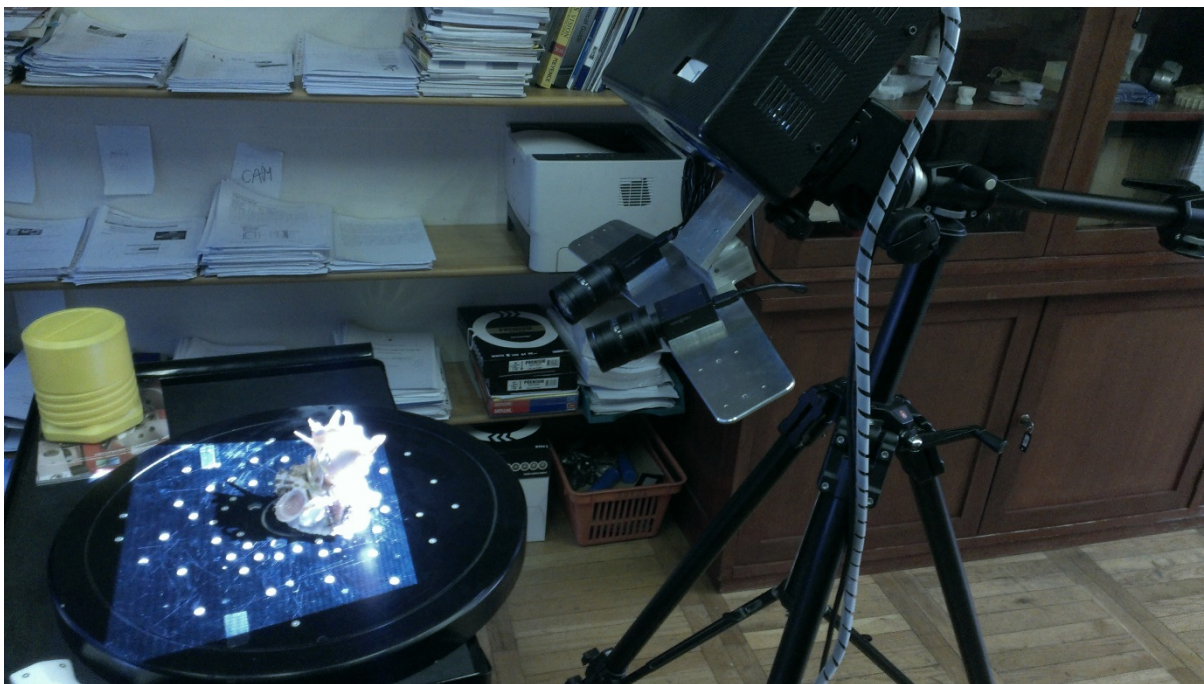
Slika 28: Skeniranje modela s srednjecenovnim skenerjem (Vir: lasten)
