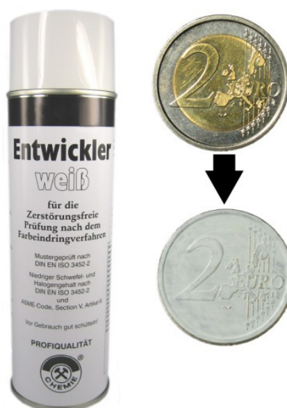
Slika 33: Sprej, ki model prekrije s tanko plastjo praška (Vir: lasten)
