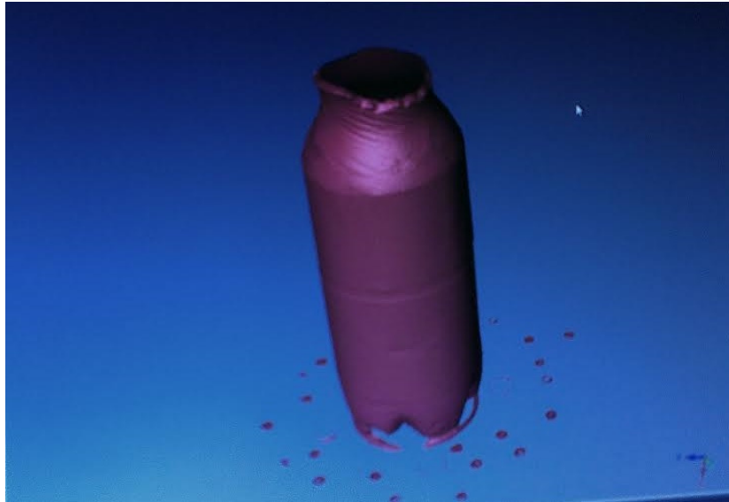
Slika 34: Steklenica, skenirana po uporabi spreja (Vir: lasten)
