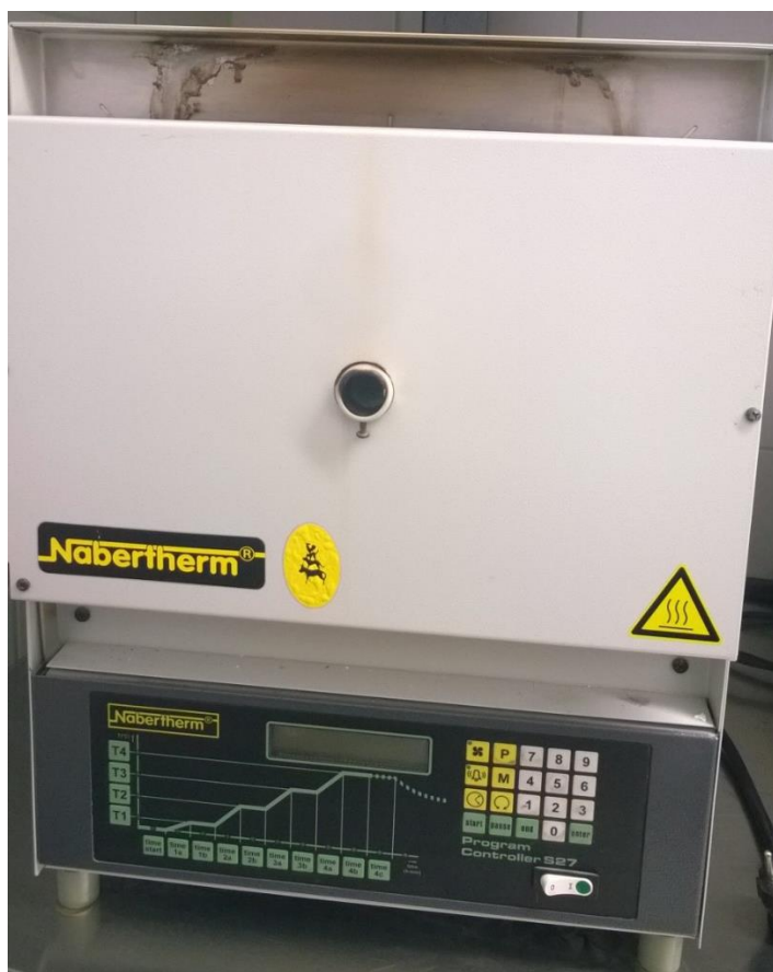
Slika 11: Peč za izgorevanje voska, lastna slika
