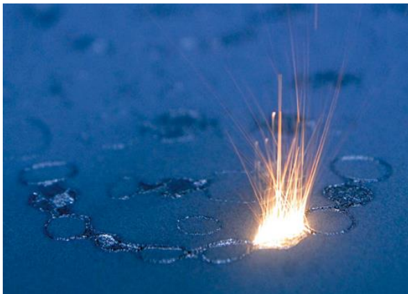
Slika 15: taljenje kovin kot način 3D-tiska, vir: [S6]
