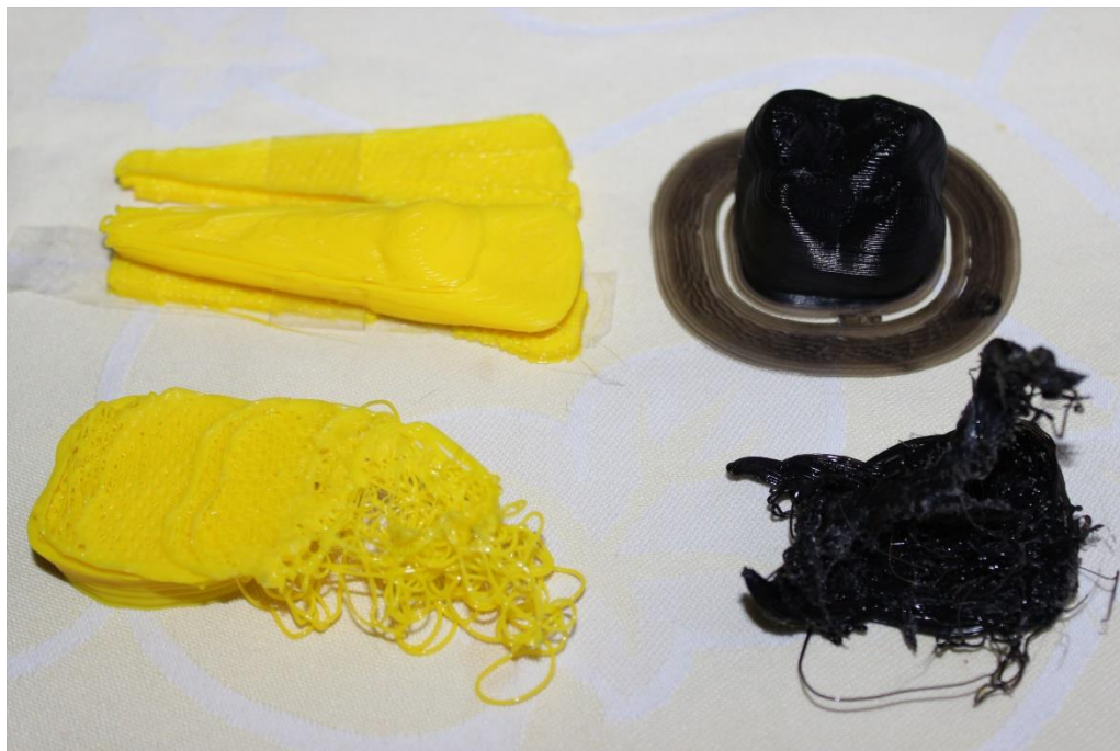
Slika 28: Primer dobro in slabo odtisnjenih plastičnih modelov zob
