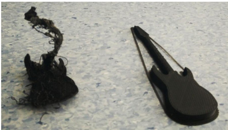
Slika 39: Neuspešno in uspešno natisnjena kitara
