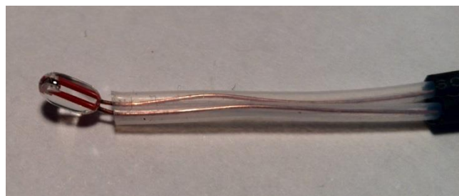
Slika 16: Senzor temperature Vir: Lasten
