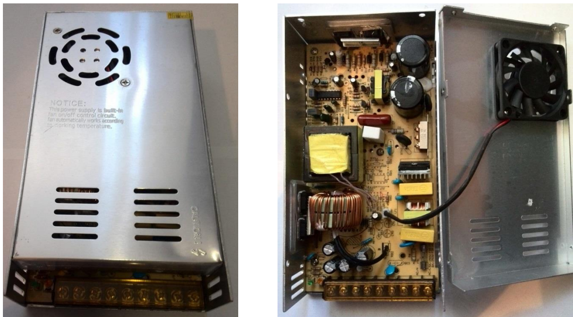
Slika 13: Napajalnik AC – DC/230V – 12V Vir: Lasten
