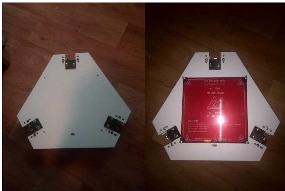
Slika 23: Iverni plošči z koračnimi motorji in tiskalno mizo Vir: Lasten
