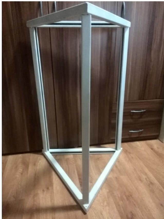
Slika 21: Ogrodje tiskalnika Vir: Lasten
