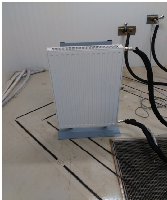
Slika 17: Radiator v preiskuševalni komori
