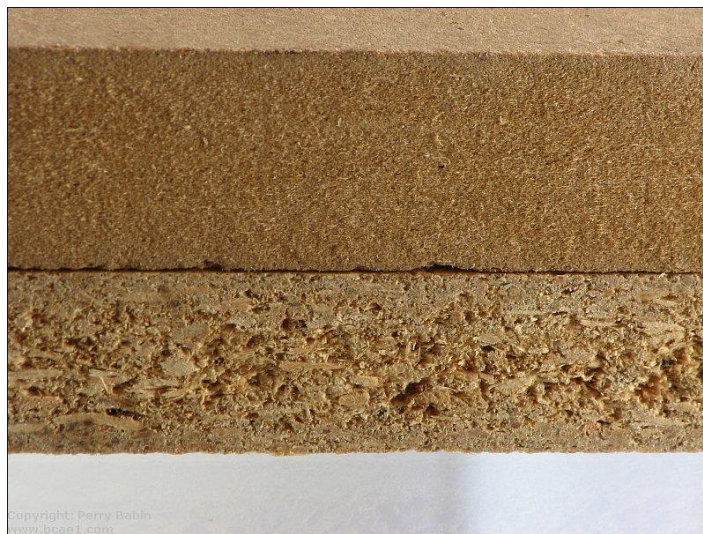
Slika 26: Primerjava strukture mediapana (zgoraj) in iverne plošče (spodaj) (Vir www.google.com )
