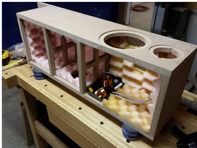
Slika 10: Primer notranjosti nedokončane zvočniške škatle z vgrajeno kretnico ter akustičnim polnilom (Vir: www.google.si )
