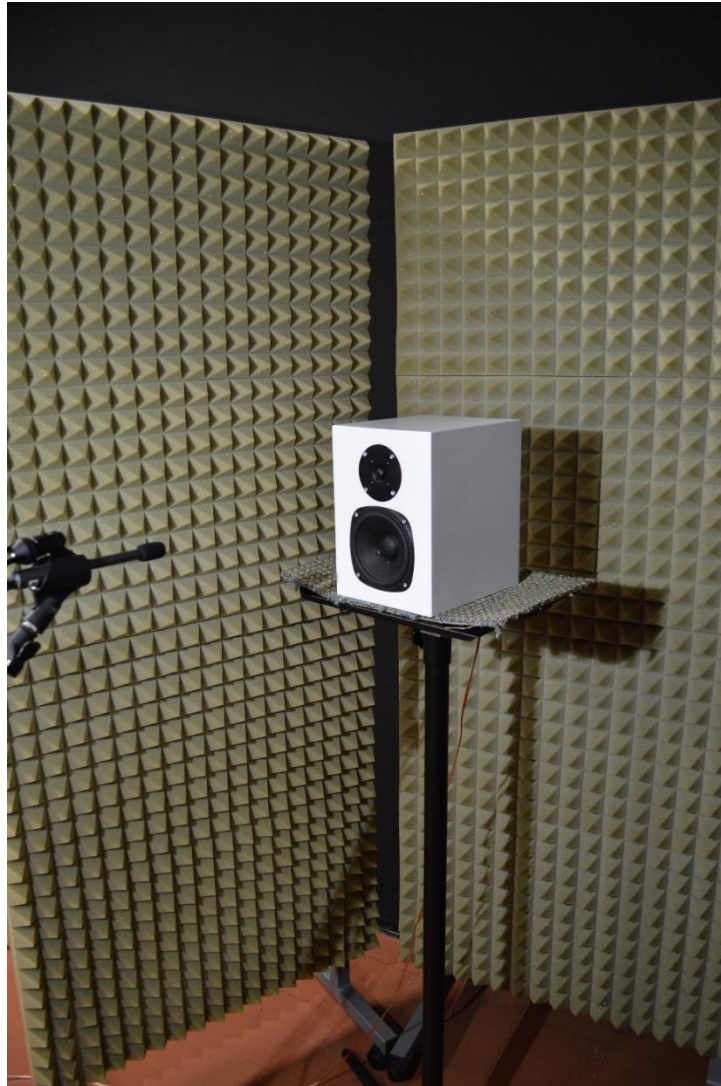
Slika 50: Postavitev zvočnika ter mikrofona med meritvijo. (Vir: Lasten)
