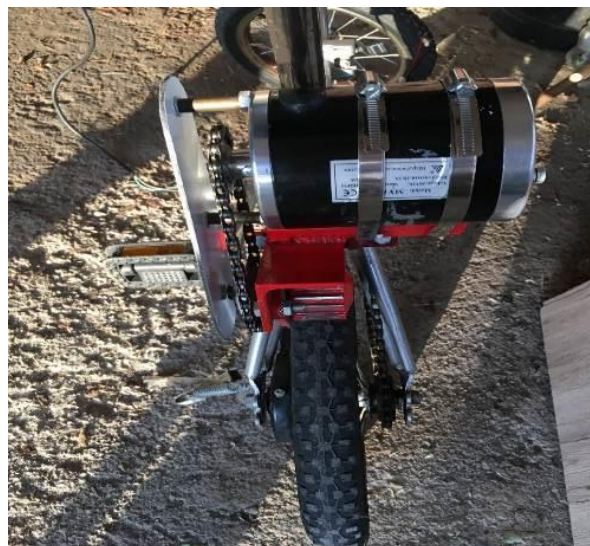
Slika 23: Držalo za motor od zadaj
