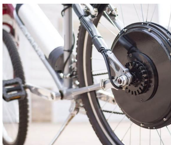
Slika 10: Motor v pestu zadnjega kolesa
