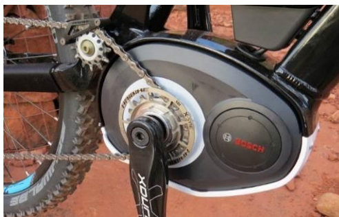
Slika 11: Motor, ki je nameščen v sredini blizu pedal
