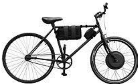
Slika 8: Konverzija(kit) v električno kolo
