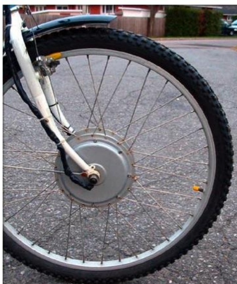
Slika 9: Motor v pestu sprednjega kolesa
