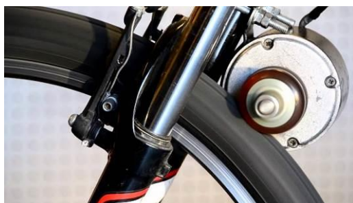
Slika 12: Direkten pogon na kolo
