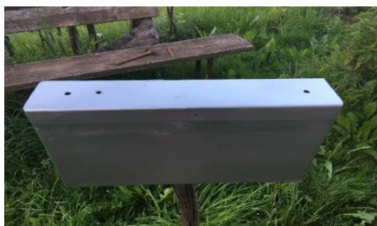
Slika 20: Stojalo za akumulatorje
