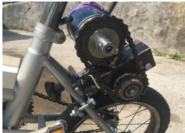
Slika 22: Držalo za motor iz vrha
