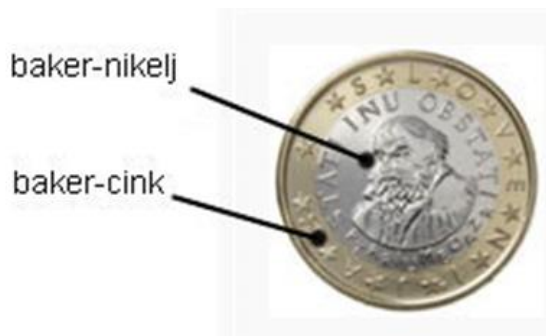
Slika 6: Zgradba kovanca za 1 evro [5]
