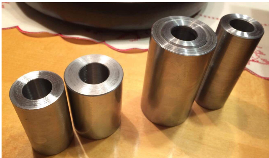
Slika 18: Pet puš, dve sta drsno uležajeni (Foto: J. Vitko)
