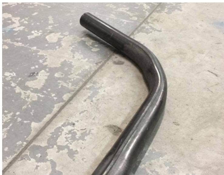
Slika 44: Deformacija cevi zaradi premajhnega premera (Foto: D.Vajdec)
