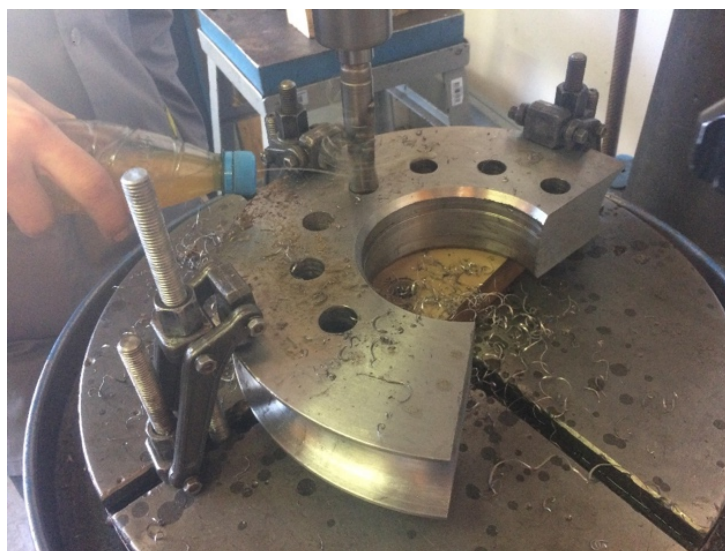
Slika 14: Vrtanje lukenj v upogibno kolo (Foto: L. Hergold)
