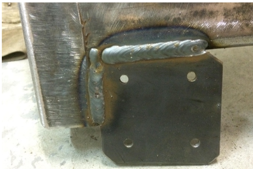
Slika 10: Privarjena ploščica na ogrodje (Foto: L. Hergold)
