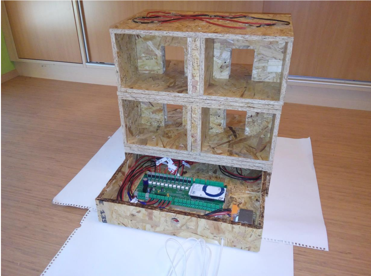
Slika 18: Model stanovanja z vezjem za krmiljenje razsvetljave
