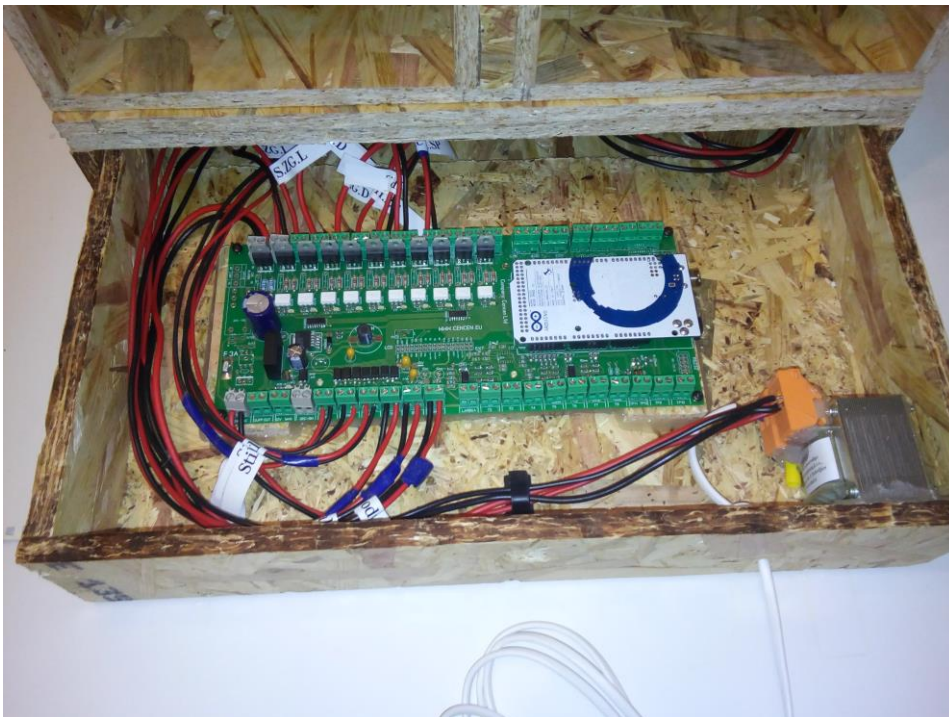
Slika 22: Predal s krmilnikom za nadzor razsvetljave
