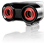
Slika 13: Ultrazvočni senzor (vir: http://legama.si/ev3 )
