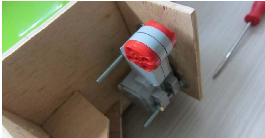
Slika 43: Vgraditev motorja (Foto: P. Vrčkovnik, 2016)
