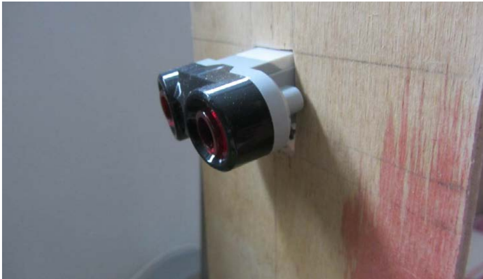
Slika 41: Vgraditev ultrazvočnega senzorja (Foto: P. Vrčkovnik, 2016)
